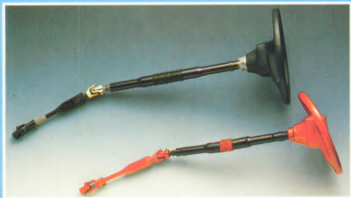
Samendrukbare stuurkolom met veiligheidsstuur.
