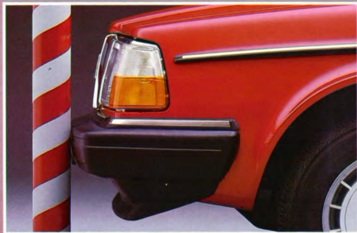
De bumpers kunnen bij aanrijdingen krachten absorberen tot snelheden van 4 km/u.
