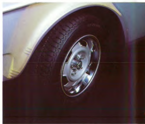
De wielkuipen van de voorwielen hebben een extra binnenscherm van kunststof. Dit beschermt het metaal tegen vuil, vocht en steenslag.
