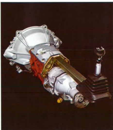
Volvo's vierversnellingsbak heeft een reputatie van grote betrouwbaarheid verworven. Enkele modellen zijn bovendien uitgerust met overdrive (gereduceerd motorgeluid en economischer brandstofverbruik).
