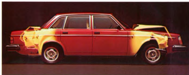
Kreukelzones voor en achter, een onwrikbare kooiconstructie van sterke staalprofielen, stalen buizen in de portieren en speciale sloten die, zelfs bij ernstige schade, het openspringen van de portieren voorkomen.
